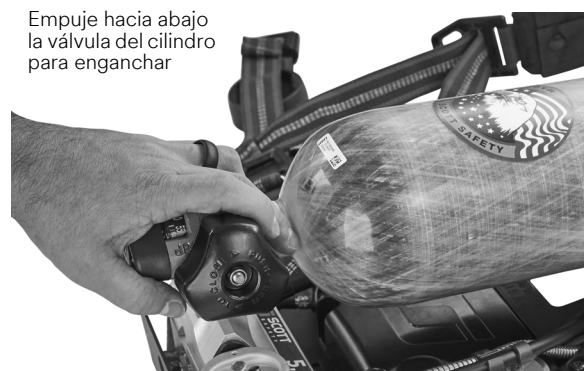
Figura 3-18 A) Verificar que el conector del cilindro esté limpio. B) Empujar el cilindro en su lugar en el bastidor.
