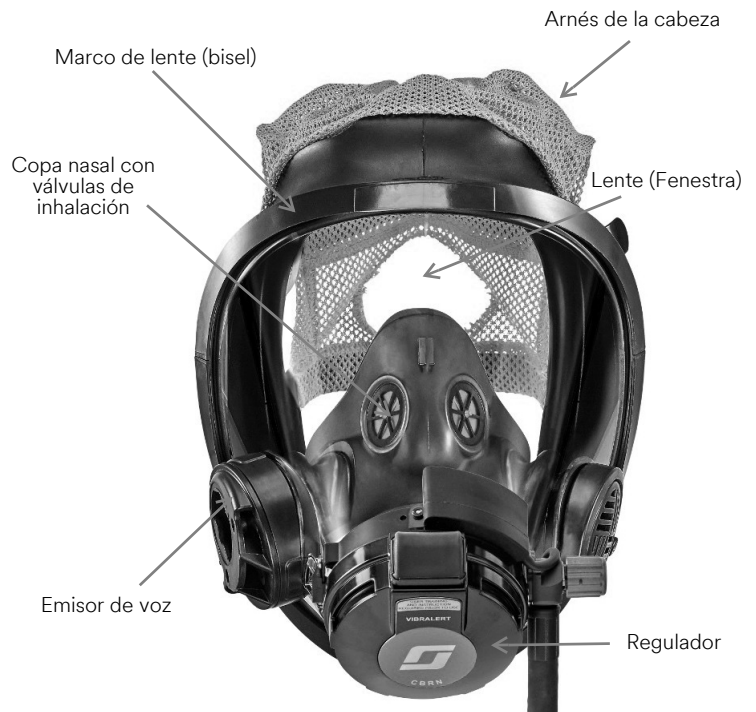
Figura 2-3 Componentes de la pieza facial (Se muestra la pieza facial 3M Scott AV-3000 HT)
