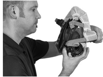
Figura 3-4 Doble el arnés de cabeza sobre la lente
